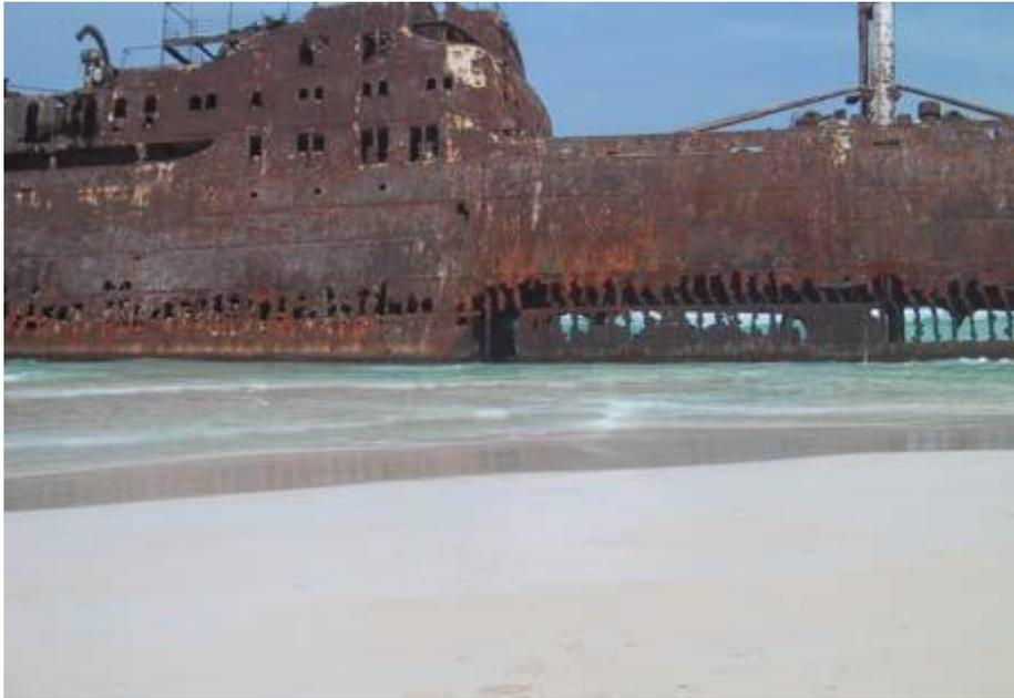
Corrosione generalizzata di un relitto navale
